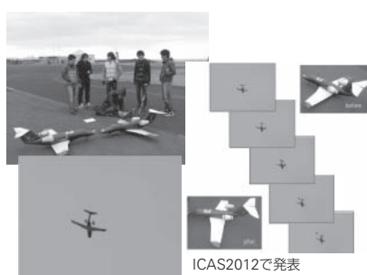
■図—12 飛行中に翼端を分離させる試験 4)
